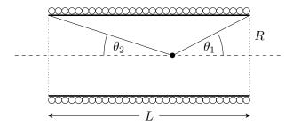
Eine gerade Kreisspule mit Länge L und Radius R besitze N Windungen pro Längeneinheit und führe den Strom I. Zeigen Sie, dass die magnetische Induktion auf der Zylinderachse (z-Achse) im Grenzfall  $NL \to \infty$  gegeben ist durch
