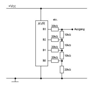
Es sollten selbstverständlich möglichst genaue Widerstände verwendet werden, also nicht unbedingt solche mit einer Toleranz von 10% oder mehr. Weiterhin empfiehlt es sich, je nach Anwendung den Ausgangsstrom über einen Operationsverstärker zu verstärken.
