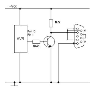
Die Drahtbrücken in der Sub-D Buchse dienen der Simulation der Hardware-Handshake Signale.
