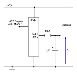
Die Werte für den Widerstand und den Kondensator hängen davon ab, wie viel Strom mit dem PWM-Signal geliefert werden soll. Es ist empfehlenswert, den Strom durch Nachschalten eines Operationsverstärkers zu erhöhen.
