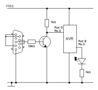
Die Drahtbrücken in der Sub-D Buchse dienen der Simulation der Hardware-Handshake Signale.
