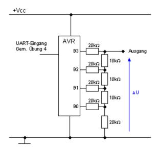
Wird eine der gewünschten Ziffern auf dem UART empfangen, so soll der entsprechende Zahlenwert auf Port B ausgegeben werden.
