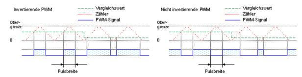
Ach ja, fast hätte ich's vergessen. Das generierte **PWM**-Signal wird am Output Compare Pin **OC1** des Timers ausgegeben und leider können wir deshalb auch nur ein einzelnes **PWM**-Signal mit dieser Methode generieren.
