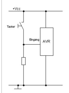
Bei dieser Methode wird der Kontakt zwischen Hier den Eingangspin des Controllers und Masse Versorgungsspannung und Masse geschaltet. geschaltet.
