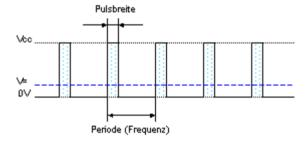
Wenn wir nun diese pulsierende Ausgangsspannung noch über ein RC-Glied filtern dann haben wir schon eine entsprechende Gleichspannung erzeugt.
