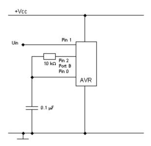
Das Prinzip der Messung ist nun dem vorhergehenden recht ähnlich. Durch Anlegen eines LOW-Pegels an Pin 2 wird der Kondensator zuerst einmal entladen. Auch hier muss darauf geachtet werden, dass der Entladevorgang genügend lang dauert.
