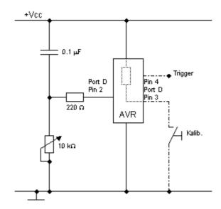
Wenn wir nun den Pin des AVR als Ausgang schalten und auf Logisch 1 (HIGH) legen, dann liegt an beiden Platten des Kondensators **Vcc** an und dieser wird entladen (Klingt komisch, mit **Vcc** entladen, ist aber so).
