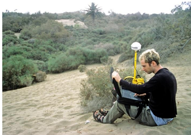
Einsatz des TRIMBLE zur genauen Vegetationsvermessung in den Dünen. (Ehrig 2001)
