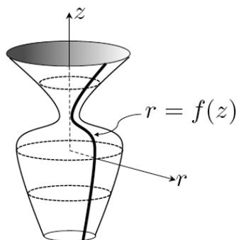
Die Rotation des Graphen  $f(z)$  um die  $z$ -Achse definiert eine Fläche. Diese Mantelfläche schließt mit den Deckflächen in der  $xy$ -Ebene bei  $z = a$  und  $z = b$  das Volumen des Rotationskörpers ein.
